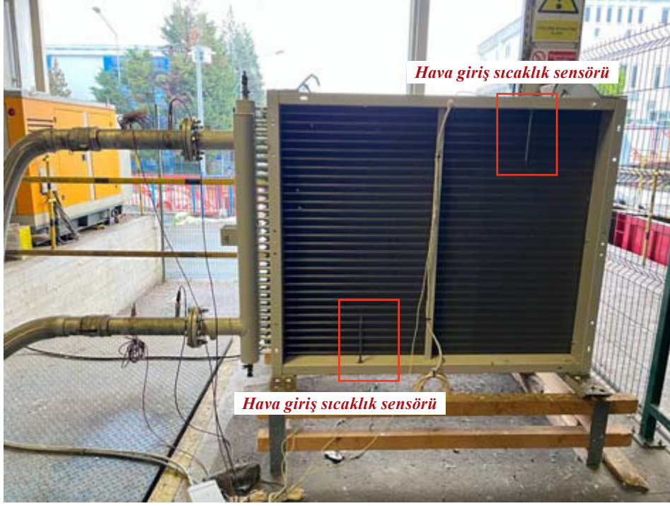
Şekil 7. Hava giriş ve çıkış sensörleri
