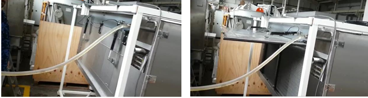
Şekil 1. Defrost Flap'in Kapalı ve Açık Durumu
