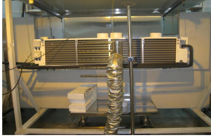
Şekil 23. Laboratuarda CO 2 Evaporatör Ürünü Testi [27]
