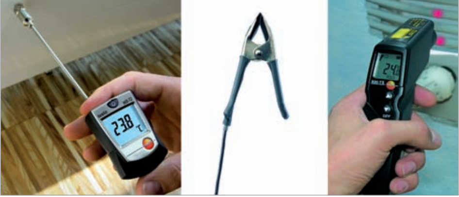
Şekil 3.35 Temaslı ve temassız (infrared) sıcaklık ölçüm cihazları
