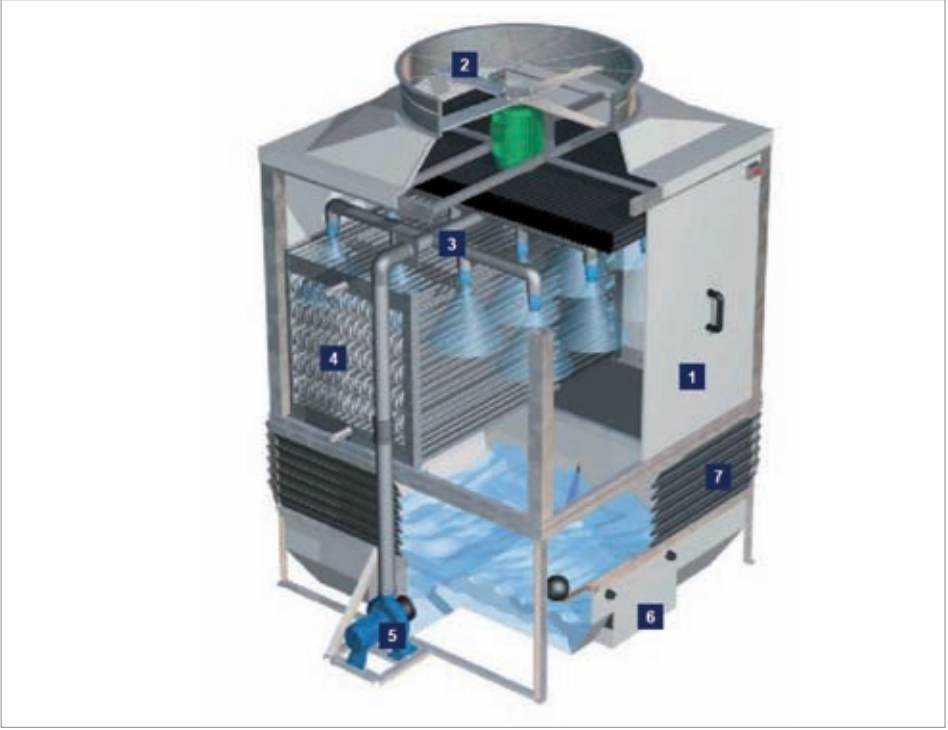
řekil 4.45 Kapalı devre su soğutma kulesi
