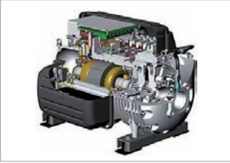
Şekil 4.8 Yarı hermetik santrifüj kompresör (Kaynak: Danfoss turbocor)
