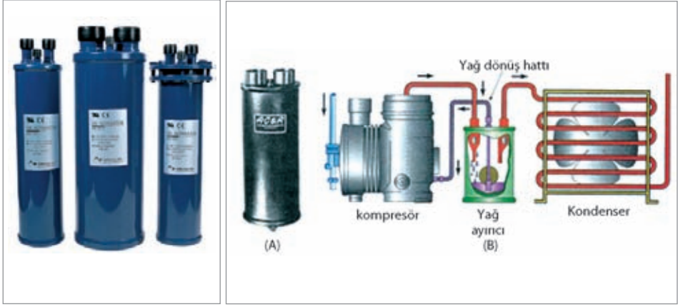
Şekil 2.43 Yağ ayırıcılar ve basit bir uygulaması
