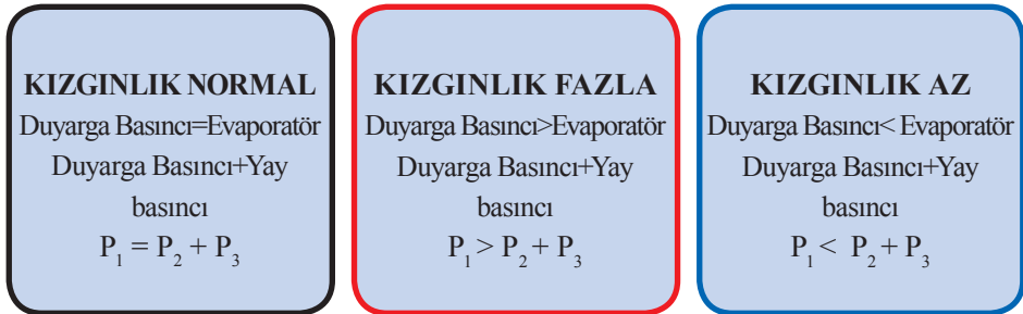
Şekil 2.35 Kızgınlık değerlerinin karşılaştırılması
