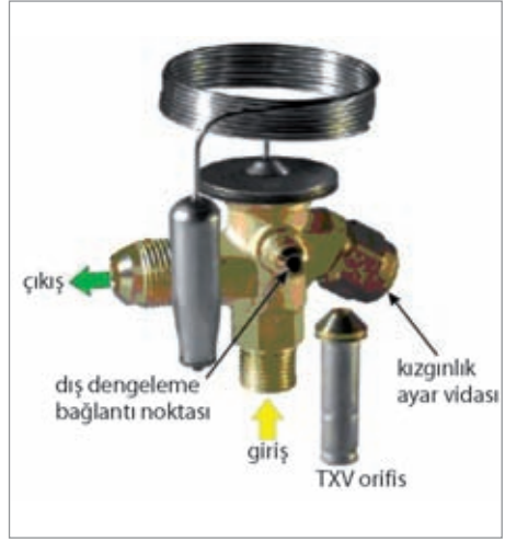
Şekil 2.36 Dıştan dengelemeli termostatik genleşme valfi ve detay resmi
